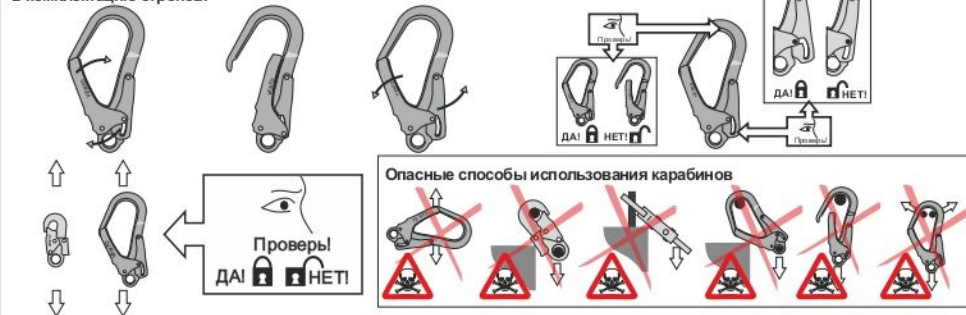
Рис. 6. Способы крепления стропов к анкерным устройствам
