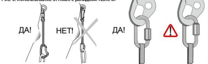
Рис. 6. Использование оттяжек с рапидами «Link 8»
