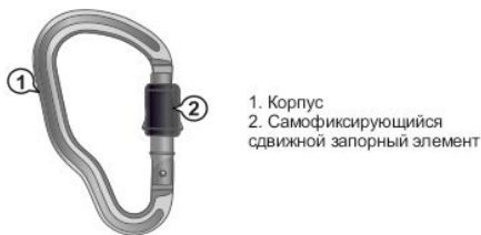
Рис. 1. Общий вид и составные детали соединительных элементов
