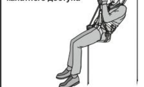
Рис. 17. Пример организации системы канатного доступа
